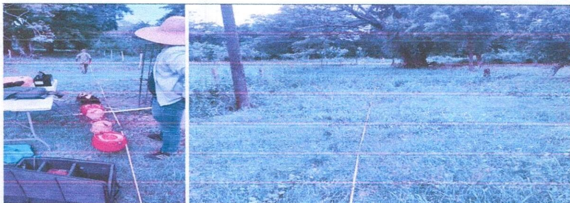
Figura. Extensión de cintas a lo largo del área de estudio para apertura de AB/2
